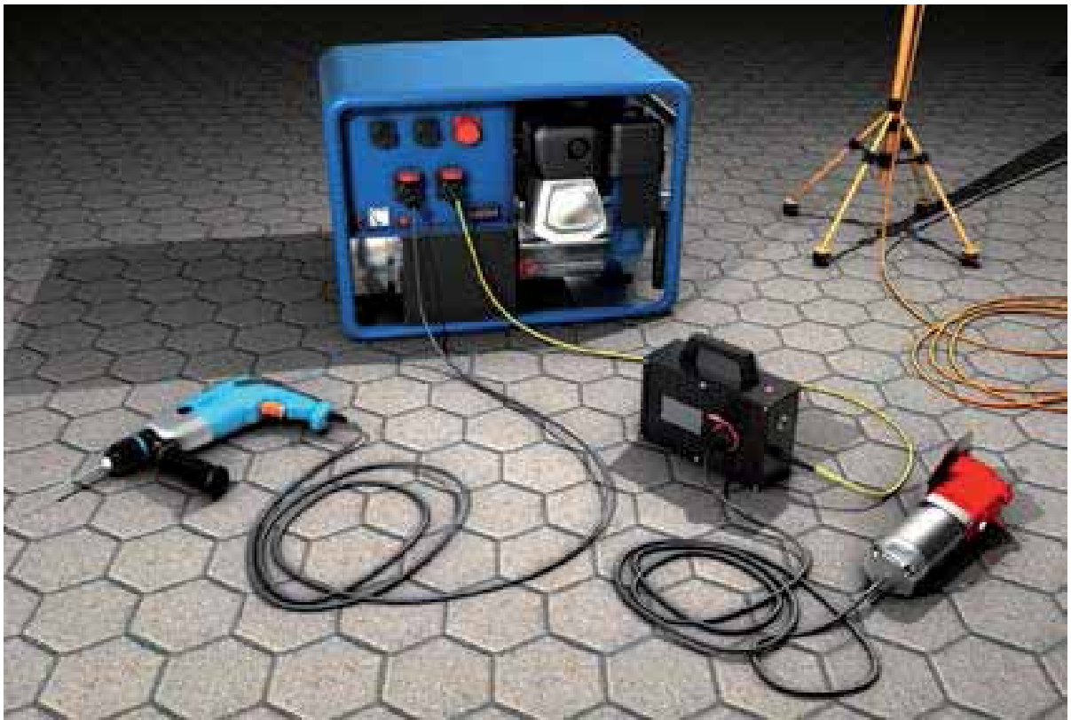
Abb. 3 Beispiel für den Betrieb eines Stromerzeugers bei erhöhter elektrischer Gefährdung.
