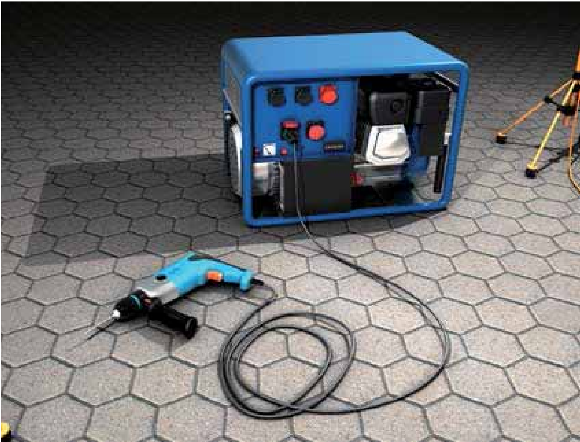
Abb. 1 ein einzelnes Betriebsmittel direkt am Stromerzeuger angeschlossen
