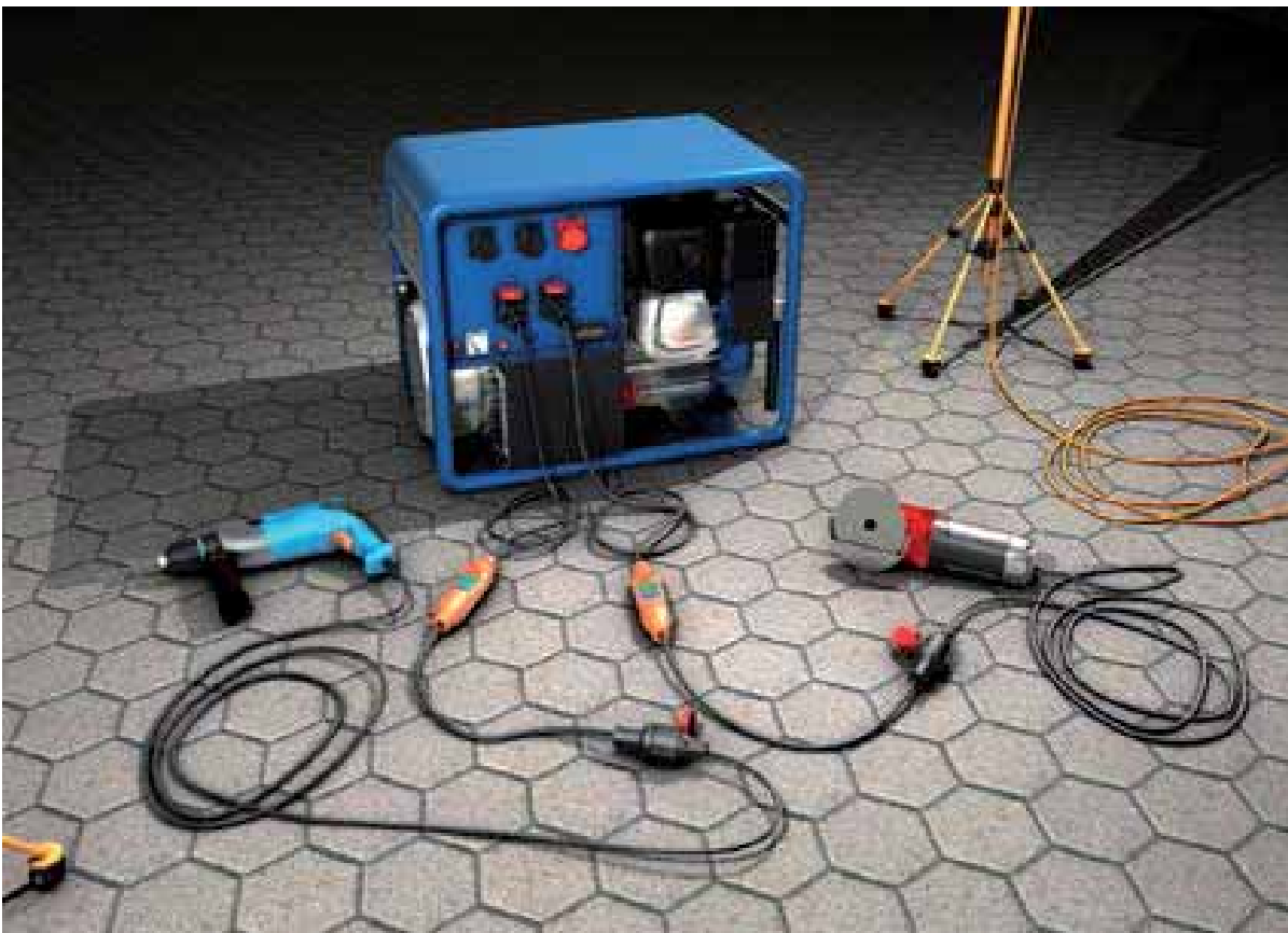
Abb. 2 Betrieb sämtlicher Betriebsmittel über jeweils eine PRCD
