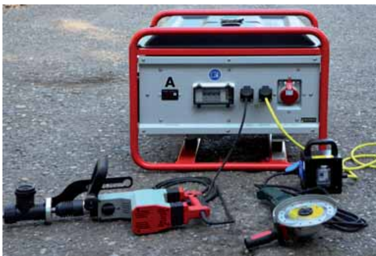
Abb. 22 Zwei Betriebsmittel – Abbruchhammer direkt angeschlossen, Winkelschleifer mit zwischengeschalteter RCD in einem Verteiler
