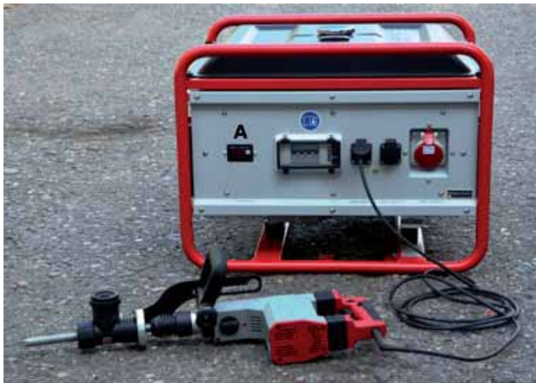
Abb. 20 Ein Betriebsmittel angeschlossen ohne weitere Schutzmaßnahme
