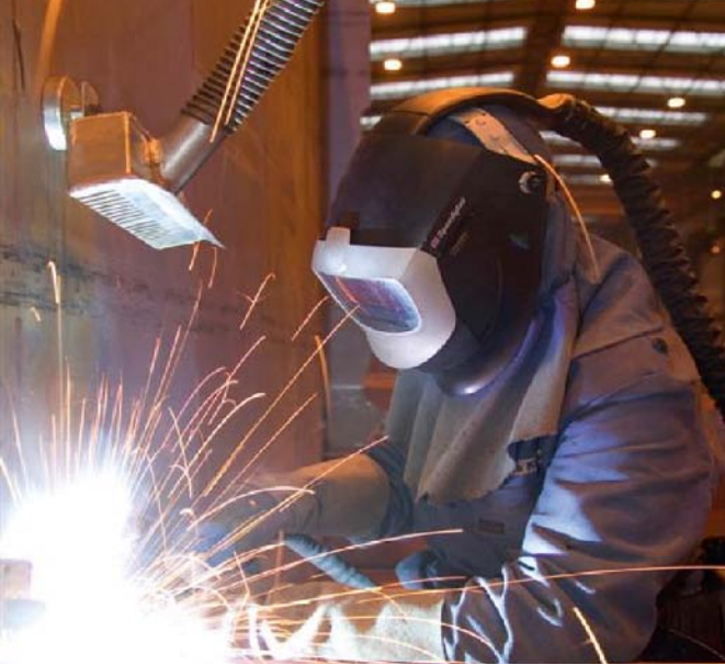
Bild 8 Schweißrauchabsaugung plus Schweißerschutzhaube mit Frischluftversorgung (persönliche Schutzausrüstung)
