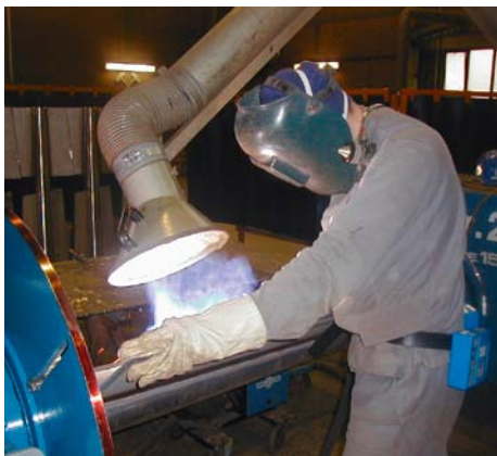
Bild 4 Absaugarm mit Erfassungselement
