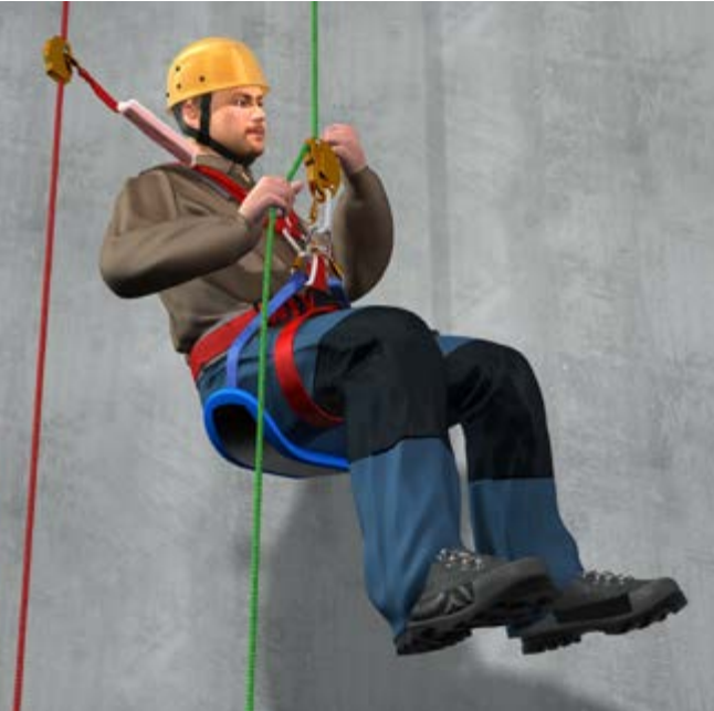
Abb. 2 Beispiel einer ergonomisch gestalteten Sitzfläche
