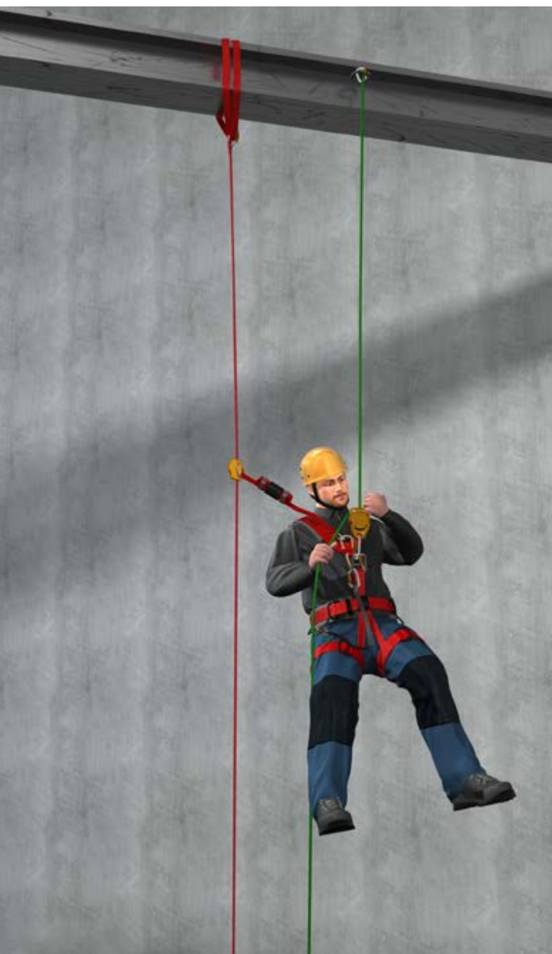
Abb. 1 Systemredundanz : unabhängig voneinander angeschlagenes Tragseil (hier grün) und Sicherungsseil (hier rot).
