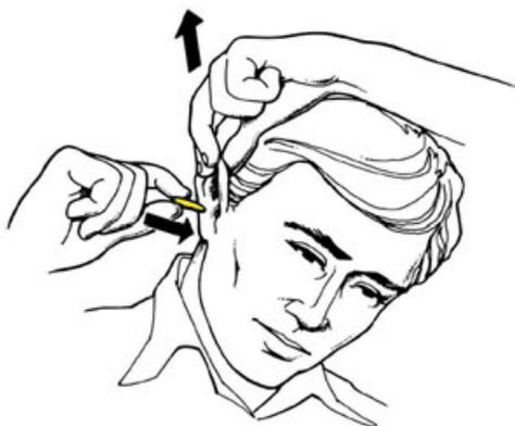
Gehörschutzstöpsel lassen sich besser in den Ohrkanal einführen, wenn dieser durch Ziehen am Ohr begradigt wird.
