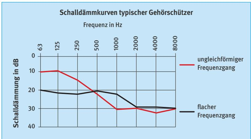
Abb. 11 Schalldämmkurven typischer Gehörschützer
