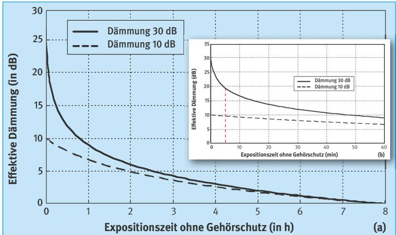
Abb. 12 Effektive Schalldämmung von Gehörschutz
