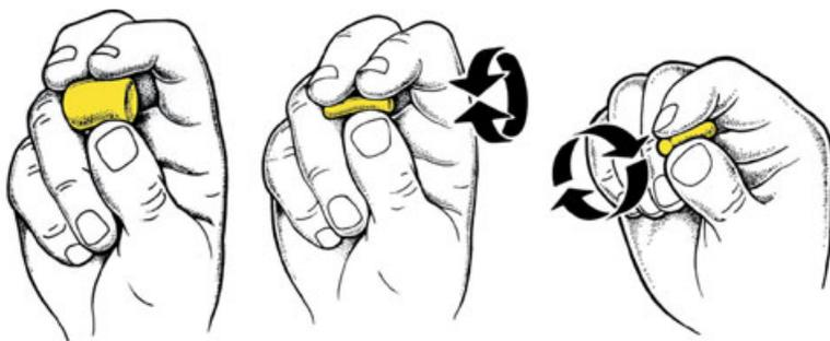
Der gerollte Gehörschutzstöpsel muss sofort in den Ohrkanal eingesetzt werden. Nur so kann man ihn mit geringem Durchmesser richtig positionieren.
