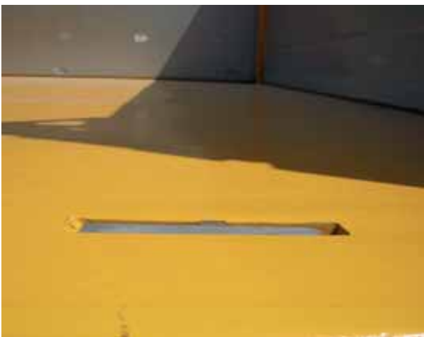
Bild 30 und 31: Dreiseitenkipper, vom Hersteller mit Zurrpunkten ausgerüstet
