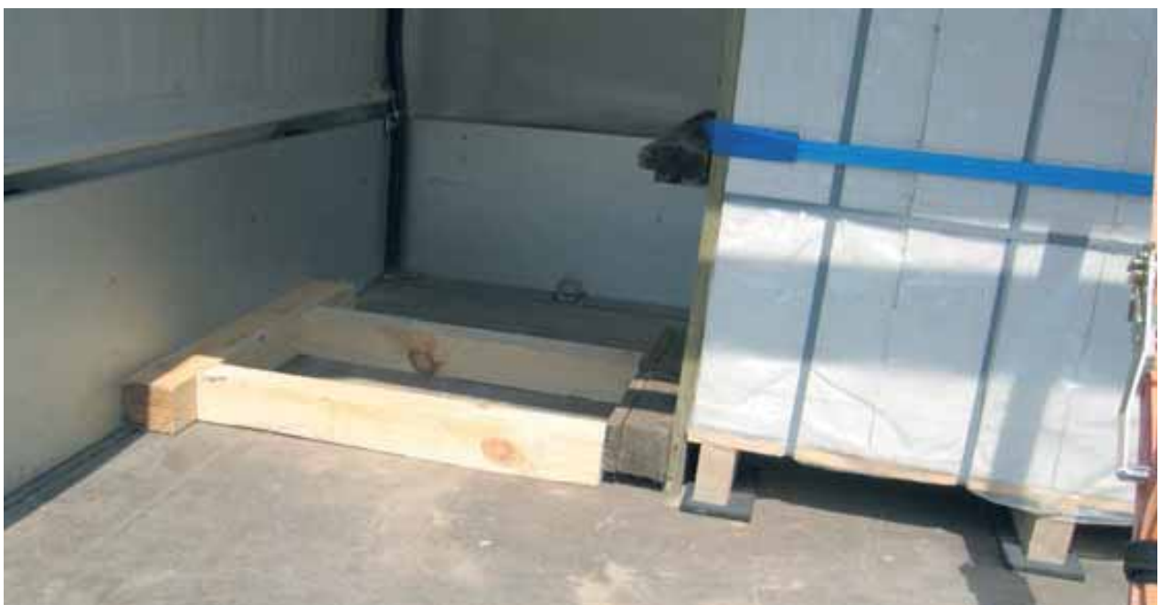
Bild 74: Mittels Holzkonstruktion formschlüssige Sicherung durchgeführt
