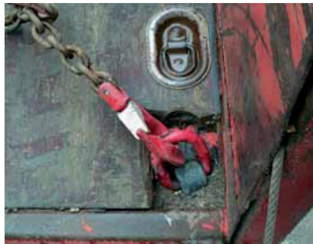
Bild 32 und 33: Dreiseitenkipper, Zurrpunkte nach Angaben der Anwender vom Hersteller/Aufbauer nachgerüstet
