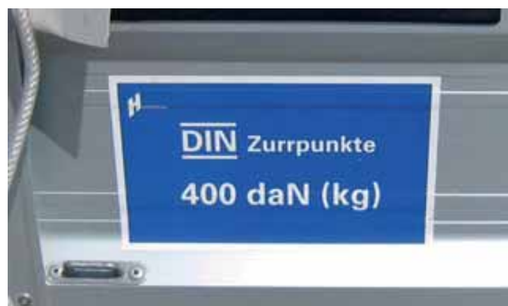
Bild 97: Kennzeichnung Zurrpunkte am Fahrzeug bzw. Tandemanhänger
