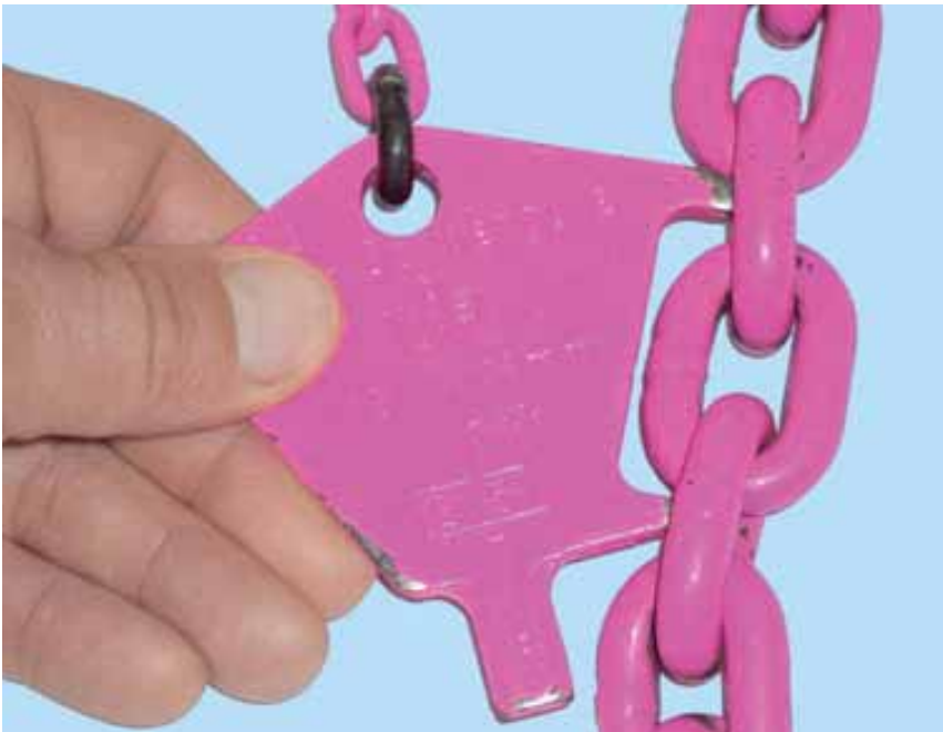
Bild 60: geprüft wird, ob sich das Einzelglied der Kette z. B. durch Überlast plastisch gelängt hat
