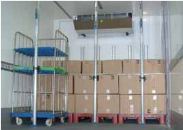
Bild 14: Formschlüssige Ladungssicherung durch die Bordwand und durch Verstellen
