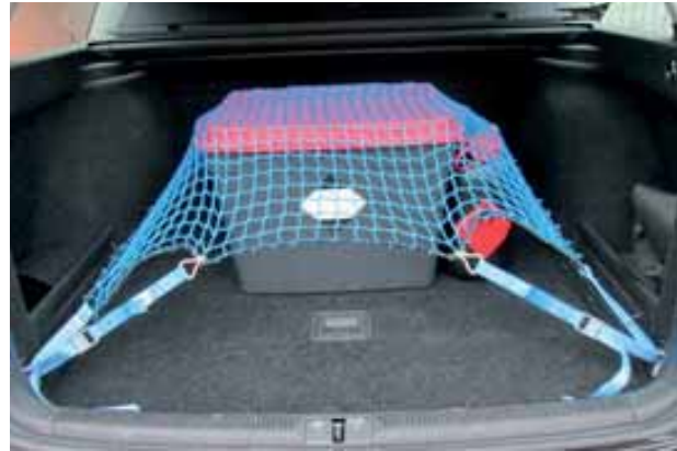
Bild 162: Außenverpackung mit einem Ladungssicherungsnetz gesichert
