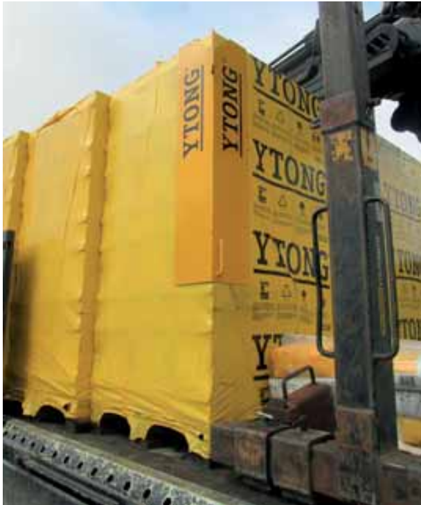
Bild 72 und 73: Zurrecken/Zurrwinkel als Hilfsmittel für eine sichere Umreifung bzw. Diagonalverzurrung
