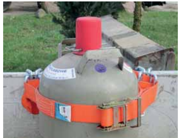
Bild 165 und 166: Sicherung einer Flüssiggasflasche mit einem Umreifungsgurt und Bordwandkrallen an der Bordwand eines Kleintransporters (Pritschenfahrzeug)
