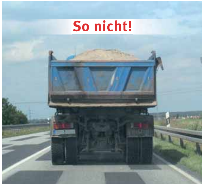
Bild 38: Schüttgut nicht gesichert
