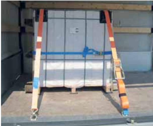
Bild 121: im Niederzurren mit zwei Zurrgurten und RHM gesichert
