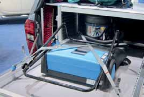
Bild 194 und 195: Details der Ausrüstung eines Fahrzeuges mit einem Ladungssicherungssystem für die Unterhaltsreinigung
