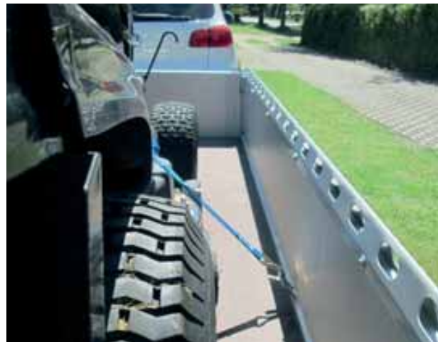
Bild 176 und 177: Niederzurren des Aufsitzrasenmähers im Bereich der Fußbretter
