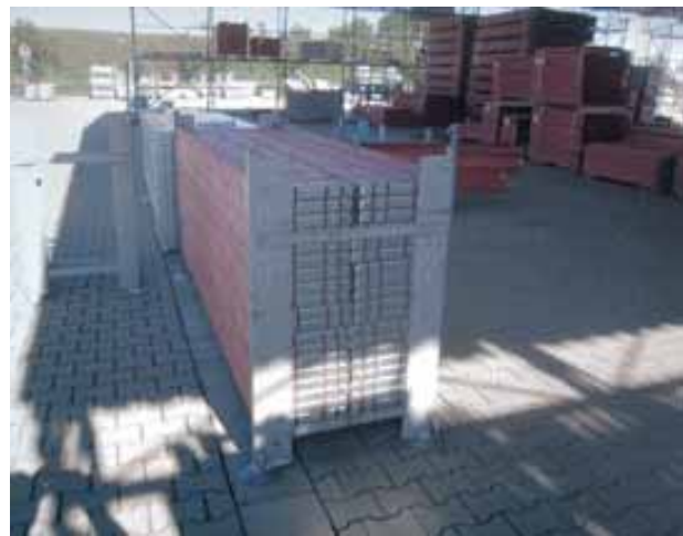
Bild 151 bis 154: Sicherer Transport von 44 Gerüstbohlen in einer Stapelbox
