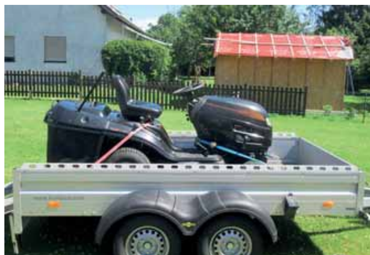
Bild 179: Sicherung des Aufsitzrasenmähers mit zwei Umreifungen (roter Zurrgurt in Fahrtrichtung, blauer Zurrgurt entgegen der Fahrtrichtung)
