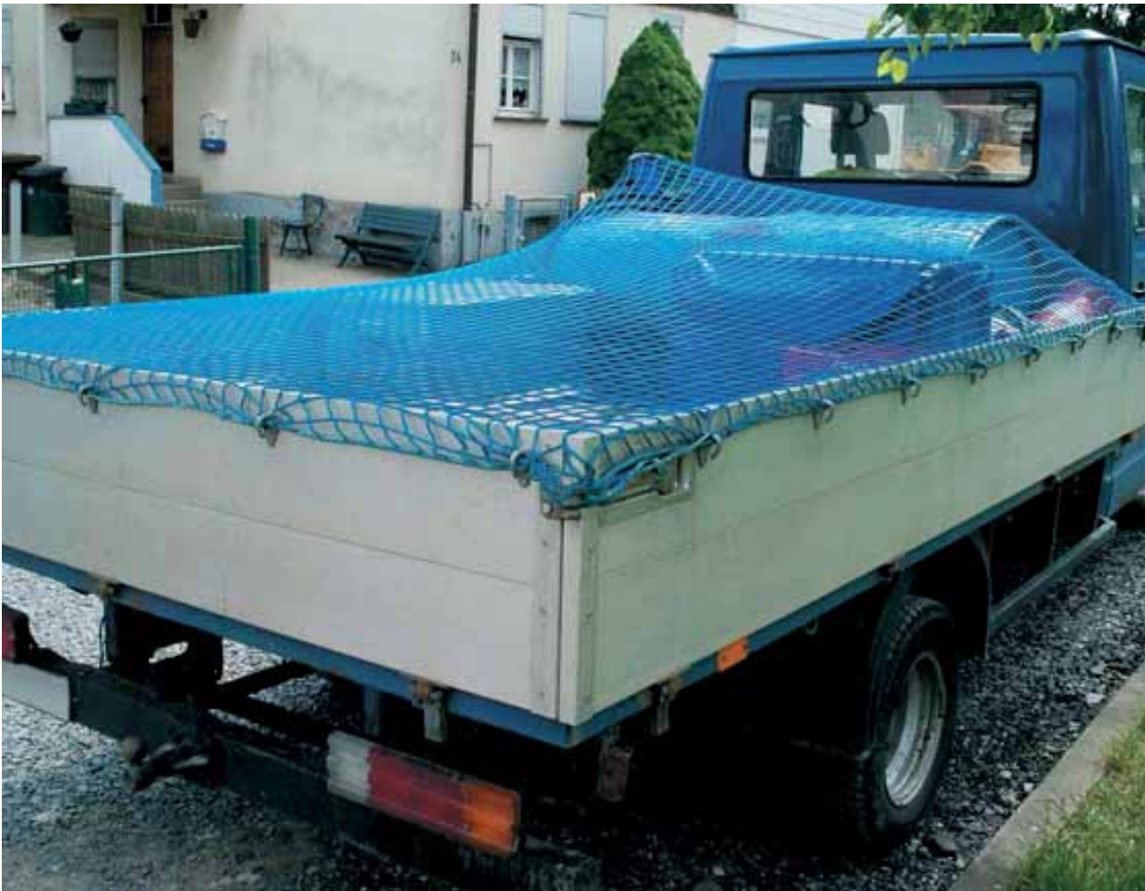
Bild 65: Verwendung von Abdecknetzen, um leichte Ladung am Wegfliegen zu hindern.
