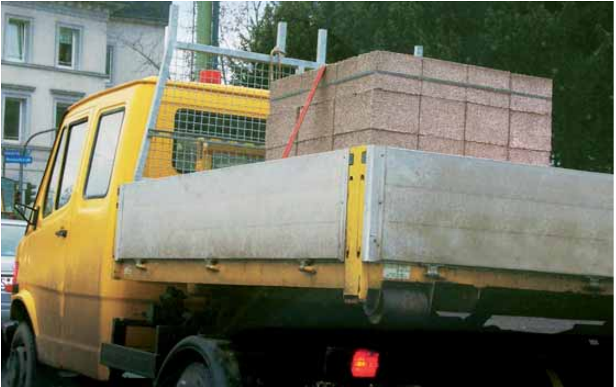
Bild 119: Versuchte Ladungssicherung eines Steinpaketes im Niederzurverfahren
