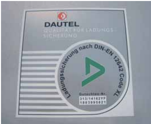
Bild 25: Kennzeichnung eines 3-Seiten-Kipper-Aufbaus, der Aufbau erfolgte nach DIN EN 12642:2007-01.
