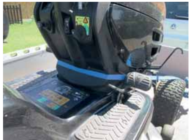
Bild 180 bis 183: Detail der Umreifung (Achtung: bei scharfen Kanten Kantenschoner verwenden)
