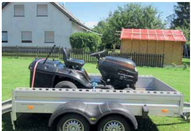
Bild 178: Sicherung des Fangkorbes am Aufsitzrasenmäher durch eine Niederzurrung
