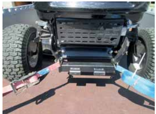
Bild 184 und 185: Nutzung der Räumschildtraverse als Zurrpunkt (Achtung: Zurrmittel müssen die gleiche Zugkraft (LC) und die gleiche Dehnung (%) aufweisen, Farbe ist nicht normt)
