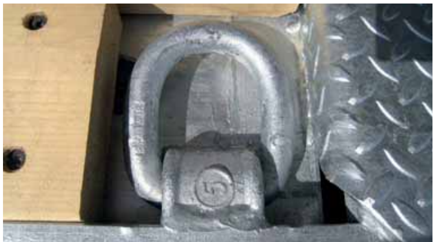
Bild 35: Bisherige Kennzeichnung von Zurrpunkten an einem Tieflader
