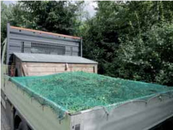
Bild 19: Abdeckung mit Netz, formschlüssige Sicherung für leichte Ladung, welche herunterwehen könnte
