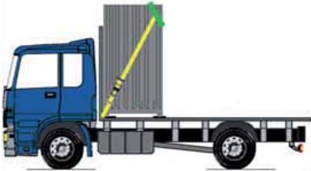
Bild 137: Sicherung der Stellrahmen auf Stellrahmenpaletten im Diagonalzurrverfahren
