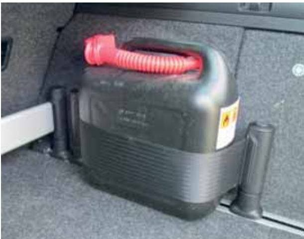
Bild 163: Sicherung eines Kraftstoffkanisters im Kofferraum mit einem Umreifungsgurt
