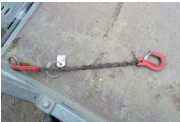
Bild 118: Kette ohne Spannelement
