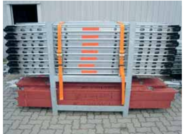
Bild 144: Bildung einer Ladeeinheit von Gerüstbelägen in der Barelle durch Umreifen bzw. Niederzurren
