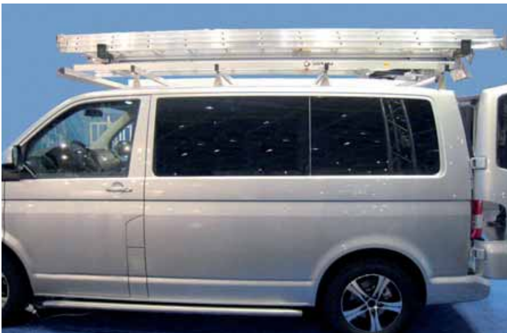
Bild 196: Leitertransport auf dem Dach
