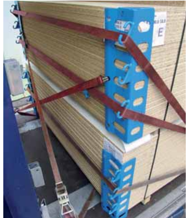
Bild 72 und 73: Zurrecken/Zurrwinkel als Hilfsmittel für eine sichere Umreifung bzw. Diagonalverzurrung
