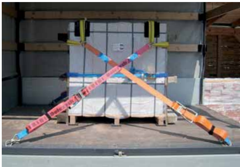
Bild 70: Sicherung eines Steinpaketes auf der Ladefläche durch Rundschlingen als Kopflaschen sowie RHM-Materialien unter der Einwegpalette
