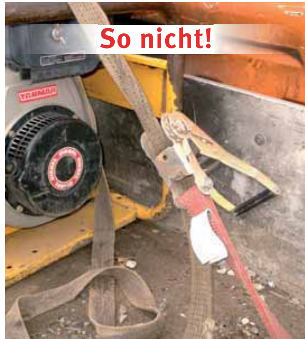
Bild 54: Nicht arretierte Zurrgurt-Ratsche und verdrehter Gurt
