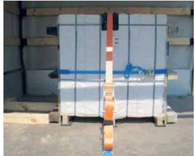
Bild 122: Im Niederzurren mit einem Zurrgurt, RHM und Blockieren gesichert
