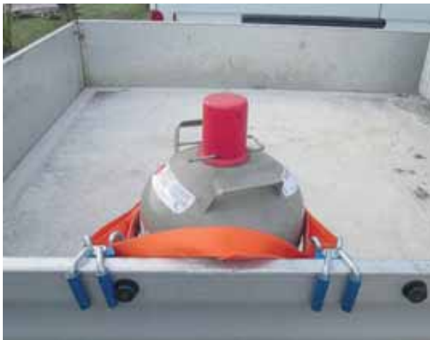
Bild 165 und 166: Sicherung einer Flüssiggasflasche mit einem Umreifungsgurt und Bordwandkrallen an der Bordwand eines Kleintransporters (Pritschenfahrzeug)
