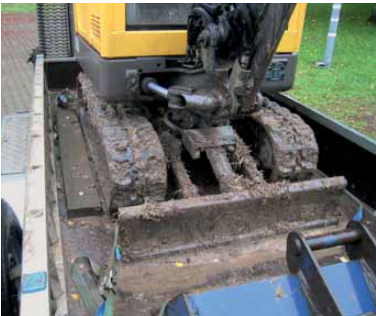
Bild 113 und 114: Mit der Ladefläche verschraubte Bohlen, um das Rutschen zur Seite zu verhindern bei Nutzung der Zurrpunkte am Fahrwerk (rechts) bzw. am Abstützschild (links). Vor der Beladung sollten die Fahrketten gereinigt werden.
