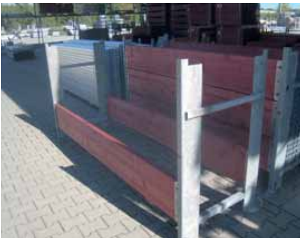
Bild 151 bis 154: Sicherer Transport von 44 Gerüstbohlen in einer Stapelbox
