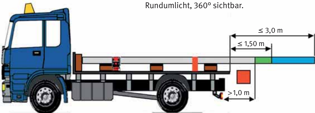
Bild 83: Längenüberschreitung eines Transportfahrzeuges
