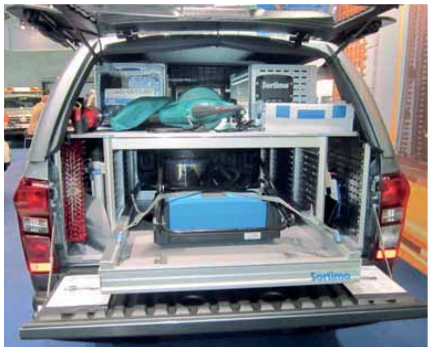
Bild 193: Ausrüstung eines Fahrzeuges mit einem Ladungssicherungssystem für die Unterhaltsreinigung
