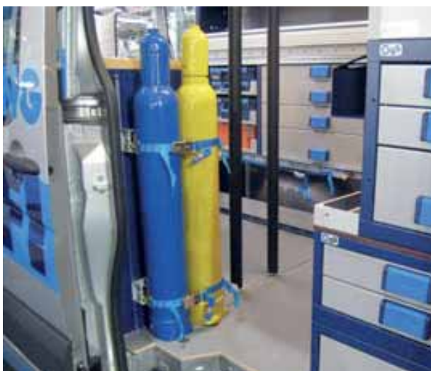
Bild 167 und 168: Sicherung von Schweißgasflaschen in einem Kastenwagen
