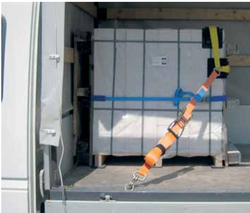
Bild 129: Steinpaket mit einem Zurrgerät und rutschhemmendem Material gesichert, gegen Verdrehen durch Blockierung an der Stirnwand gesichert
