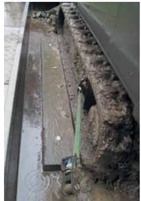
Bild 113 und 114: Mit der Ladefläche verschraubte Bohlen, um das Rutschen zur Seite zu verhindern bei Nutzung der Zurrpunkte am Fahrwerk (rechts) bzw. am Abstützschild (links). Vor der Beladung sollten die Fahrketten gereinigt werden.
