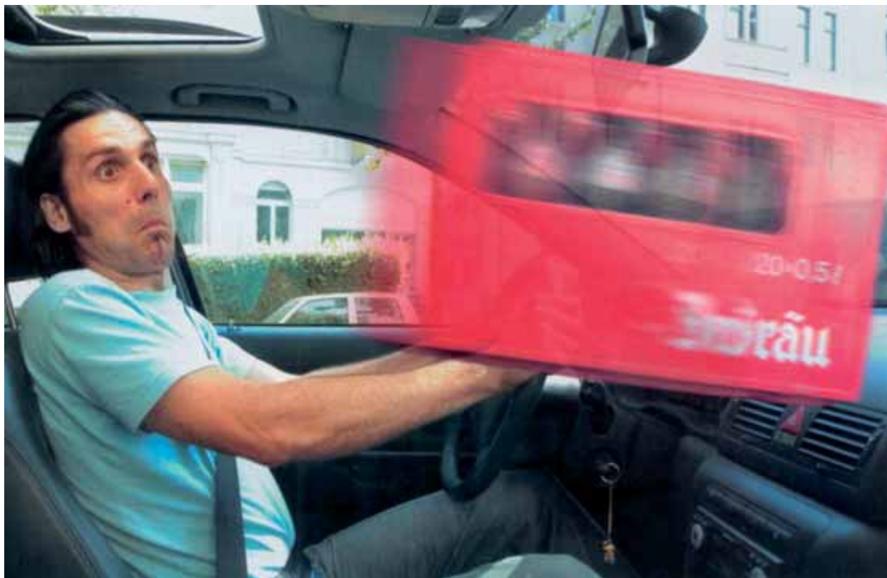
Bild 2: Bei der Vollbremsung entwickelt der ca. 18 kg schwere Getränkekasten die Wucht von 1 t .
