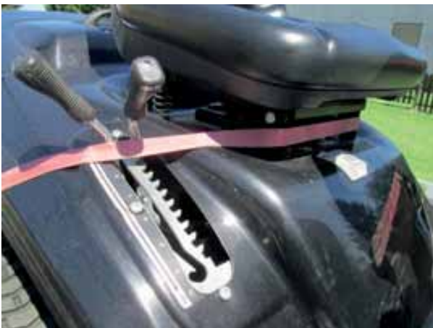
Bild 180 bis 183: Detail der Umreifung (Achtung: bei scharfen Kanten Kantenschoner verwenden)
