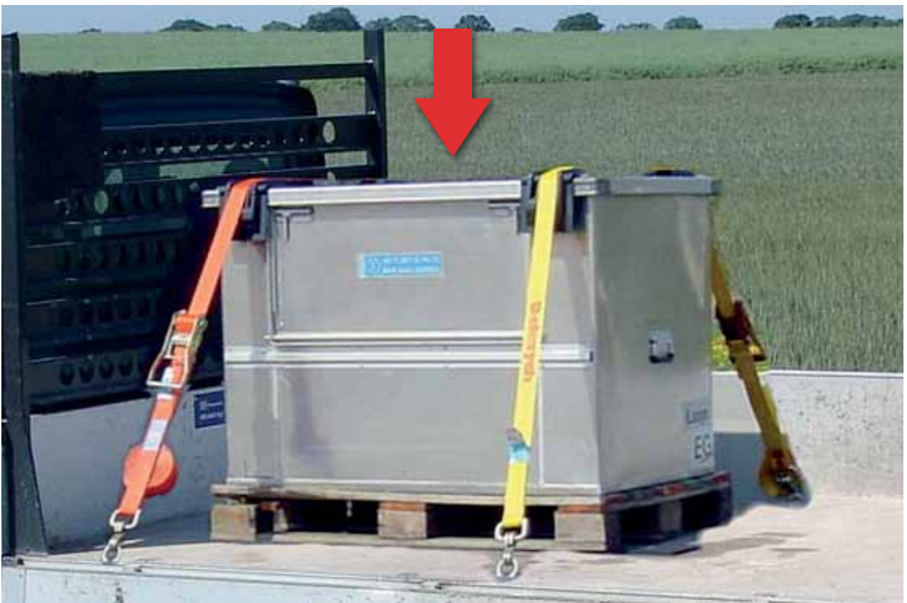
Bild 21: Niederzurren, durch Vorspannung der Gurte über die Ratsche wird eine „Erhöhung des Eigengewichtes“ erreicht
