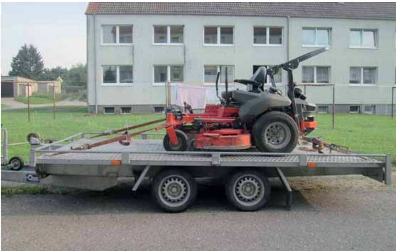
Bild 188: Aufsitzrasenmäher mit einem Gewicht von ca. 625 kg auf einem Tandemanhänger im Diagonalzurrverfahren gesichert
