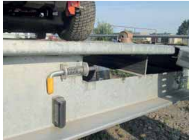
Bild 186 und Bild 187: In Ablagefächern unter der Ladefläche verstaute Auffahrrampen
