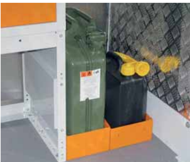
Bild 164: Sicherung von Kraftstoffkanistern in Blockiereinrichtungen/Halterungen
