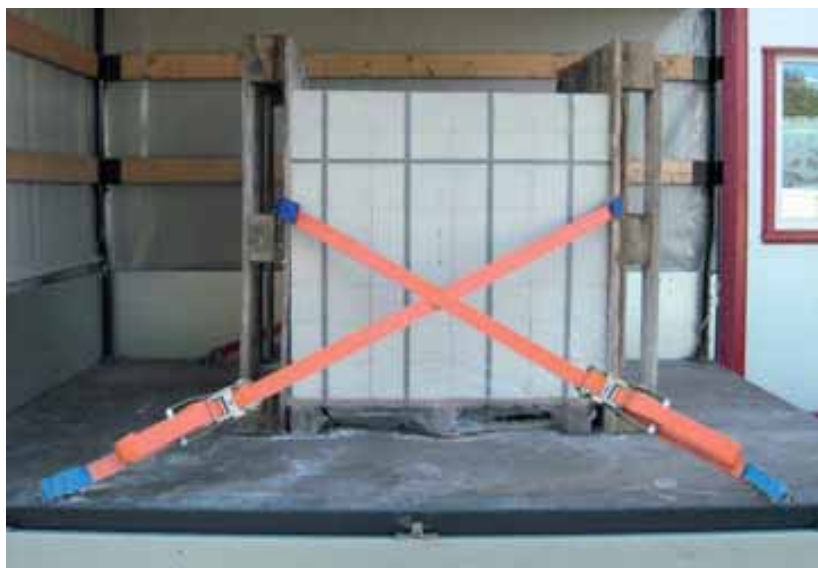
Bild 71: Mittels Paletten formschlüssige Sicherung durchgeführt
