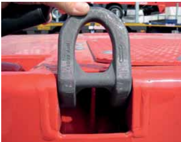
Bild 36 und 37: Neue Kennzeichnung von Zurrpunkten an Tiefladern
