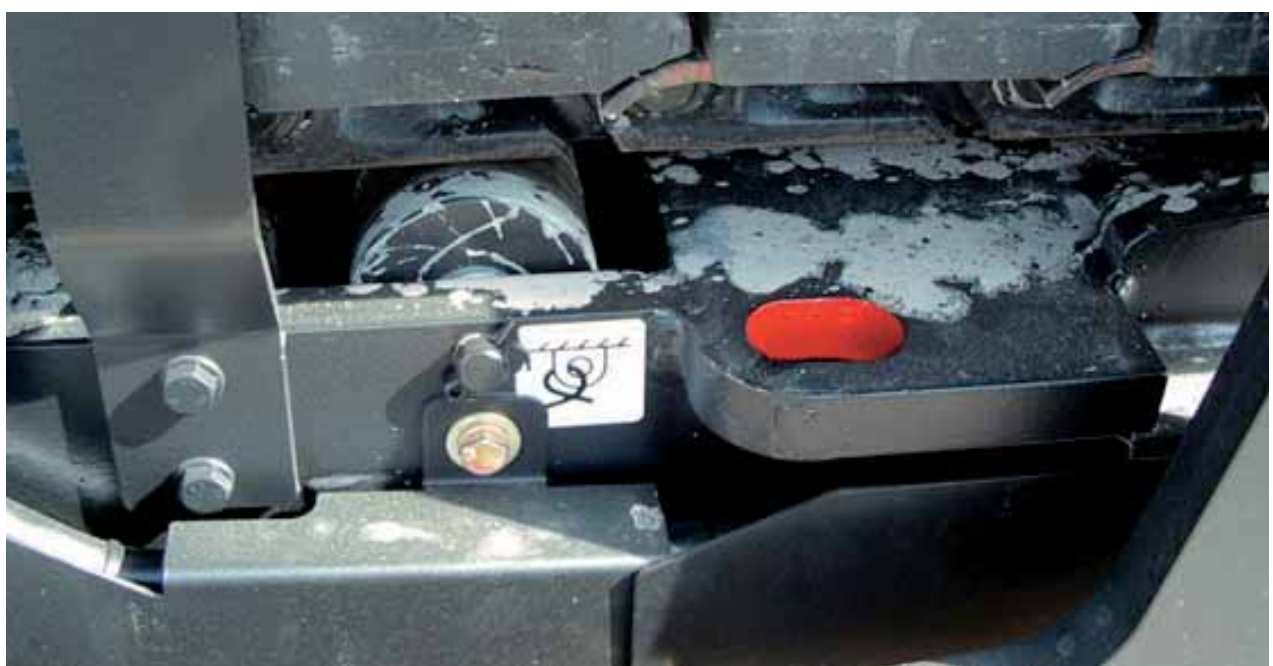
Bild 41: Kennzeichnung eines Zurrpunktes an einem Straßenfertiger
