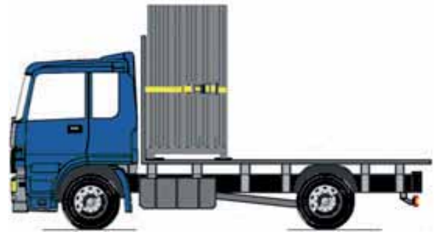
Bild 138: Sicherung der Stellrahmen auf Stellrahmenpaletten mit waagerechter Umreifung bei vorhandenen Zurrpunkten an der Stirnwand
