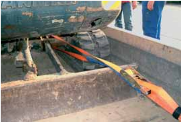
Bild 115: Sicherung am Fahrwerk
