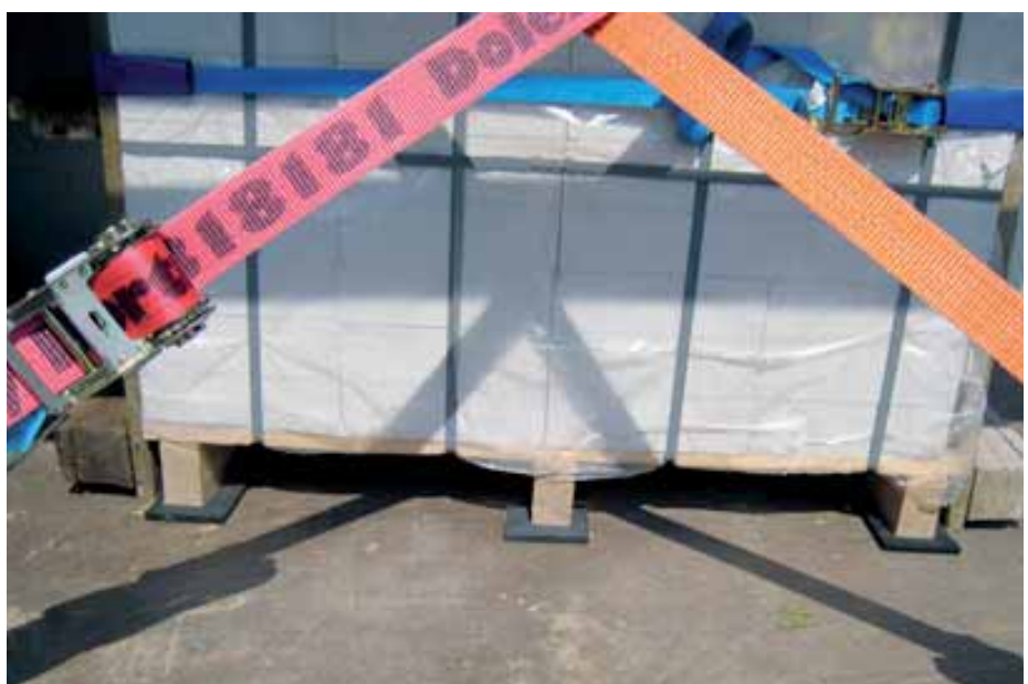
Bild 10: Einsatz von Anti-Rutschmatten unter einem Steinpaket
