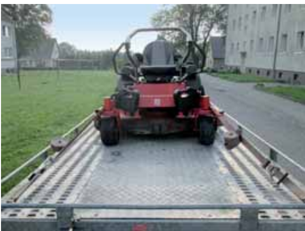
Bild 189 und 190: Diagonalzurren mit Zurrgurten, Zulässige Zugkraft der Zurrpunkte am Tandemanhänger lt. Hersteller 850 daN
