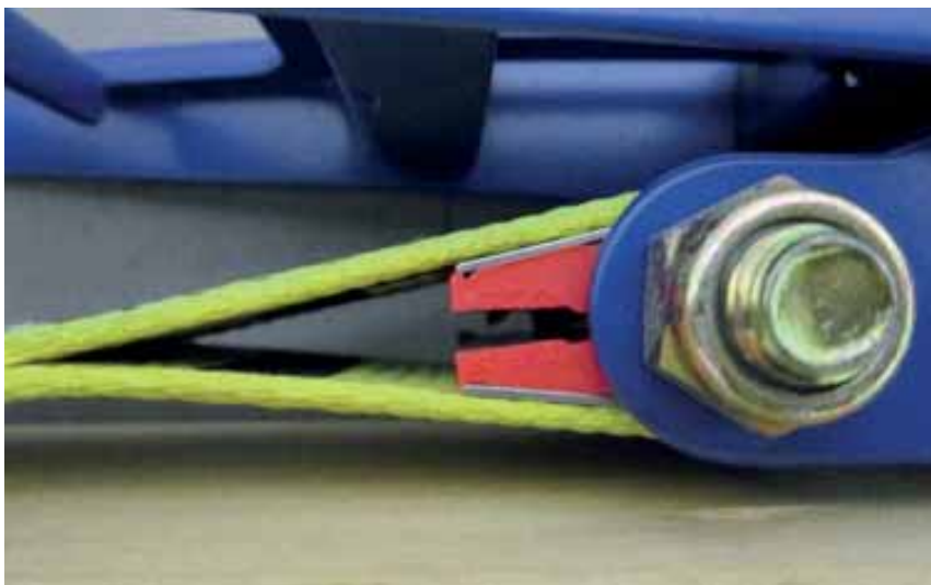
Bild 88 und 89: Vorspannmessgerät, oben Fa. Dolezych, unten Fa. SpanSet (TFI)
