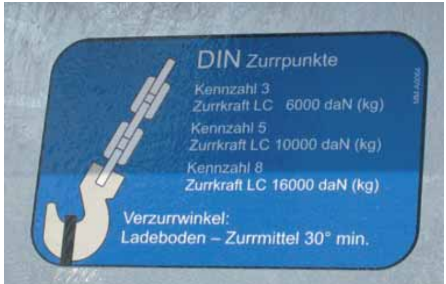
Bild 34: Kennzeichnung und Belastbarkeit der Zurrpunkte an einem Tieflader
