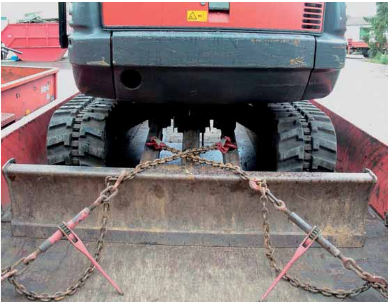
Bild 42: Zurrpunkte am Bagger durch das Bau-Unternehmen in Abstimmung mit dem Hersteller nachgerüstet.
