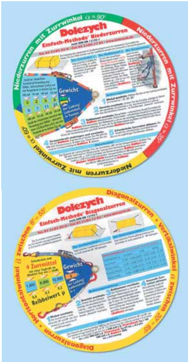
Bild 84: Schablone „Trucker-Disc“ zur Ermittlung der Anzahl der erforderlichen Zurrgurte
