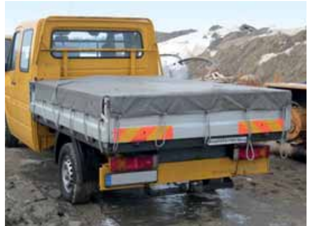
Bild 20: Abdeckung mit Plane, formschlüssige Sicherung für leichte Ladung, welche herunterwehen könnte
