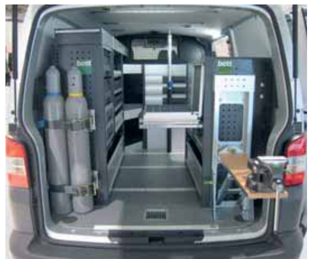
Bild 167 und 168: Sicherung von Schweißgasflaschen in einem Kastenwagen
