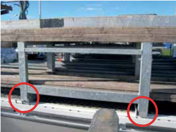
Bild 143: Auf der Ladefläche sind Stahlwinkel befestigt. Diese verhindern ein Verrutschen der Barelle in Fahrzeuglängsachse.
