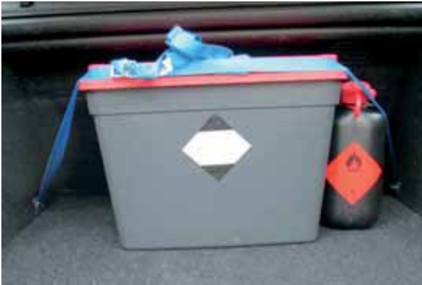
Bild 161: Außenverpackung mit einem Umreifungsgurt (einteiliger Zurring) gesichert
