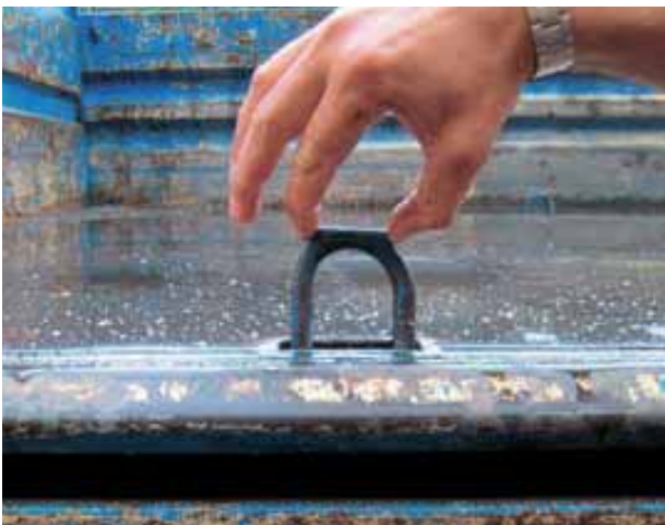
Bild 32 und 33: Dreiseitenkipper, Zurrpunkte nach Angaben der Anwender vom Hersteller/Aufbauer nachgerüstet
