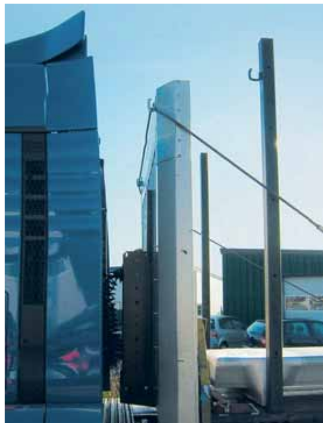
Bild 26 und 27: „Stabilisierung“ der Stirnwand. Hierzu kann um die Stirnwand ein Zurrmittel gelegt werden. Dieses wird erst nach der Beladung handfest vorgespannt und vor der Entladung entspannt.
