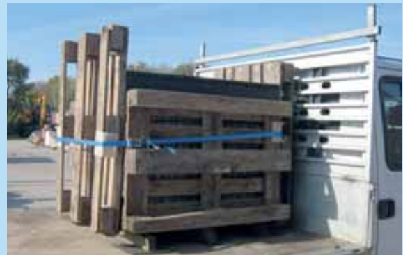
Paletten mit Umreifungsgurt und Kantenschutz verzurren
