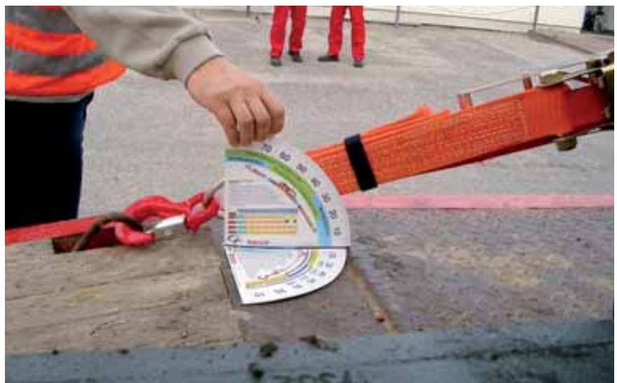
Bild 84: Schablone „Trucker-Disc“ zur Ermittlung der Anzahl der erforderlichen Zurrgurte
