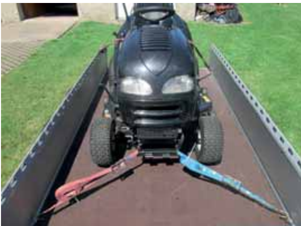
Bild 184 und 185: Nutzung der Räumschildtraverse als Zurrpunkt (Achtung: Zurrmittel müssen die gleiche Zugkraft (LC) und die gleiche Dehnung (%) aufweisen, Farbe ist nicht normt)
