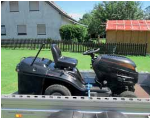
Bild 176 und 177: Niederzurren des Aufsitzrasenmähers im Bereich der Fußbretter
