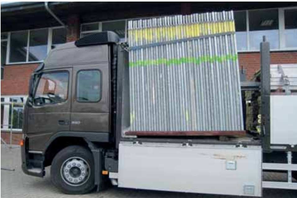
Bild 132: Stehender Transport von Gerüststellrahmen mit Formschluss an der Bordwand
