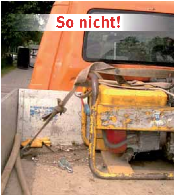
Bild 53: Nicht zulässiges Knoten von Zurrgurten
