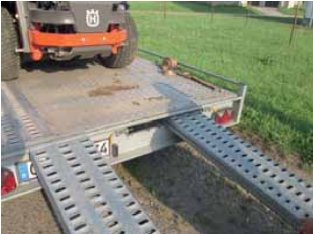
Bild 186 und Bild 187: In Ablagefächern unter der Ladefläche verstaute Auffahrrampen
