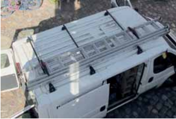
Bild198: Leitertransport auf dem Dach mit Sicherung, siehe Details
