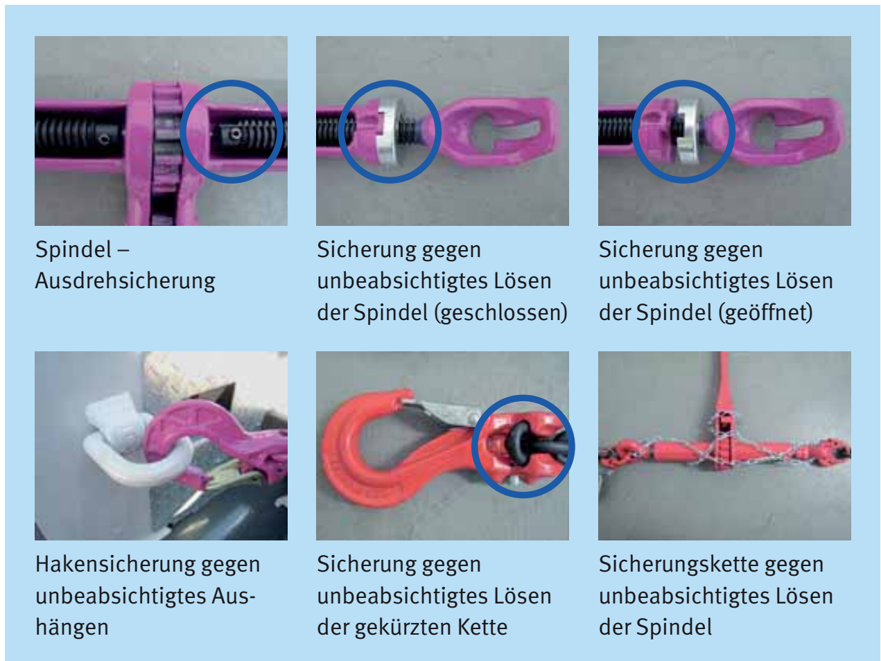
Bild 59: Sicherungselemente an einer Zurrkette nach DIN EN 12195-3:2001
