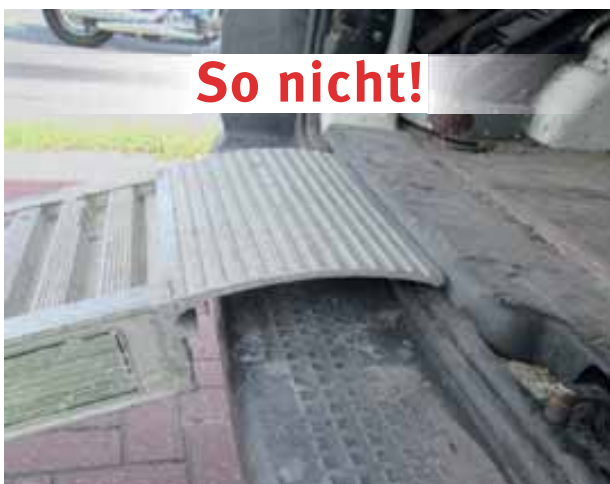
Bild 172: nicht bestimmungsgemäße Verwendung einer Anhängerauffahrrampe am Kastenfahrzeug, nicht arretiert
