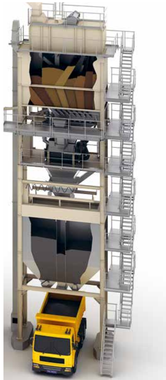
Abb. 51 Schematische Darstellung eines Mischturmes mit horizontal beweglichem Verfahrkübel
