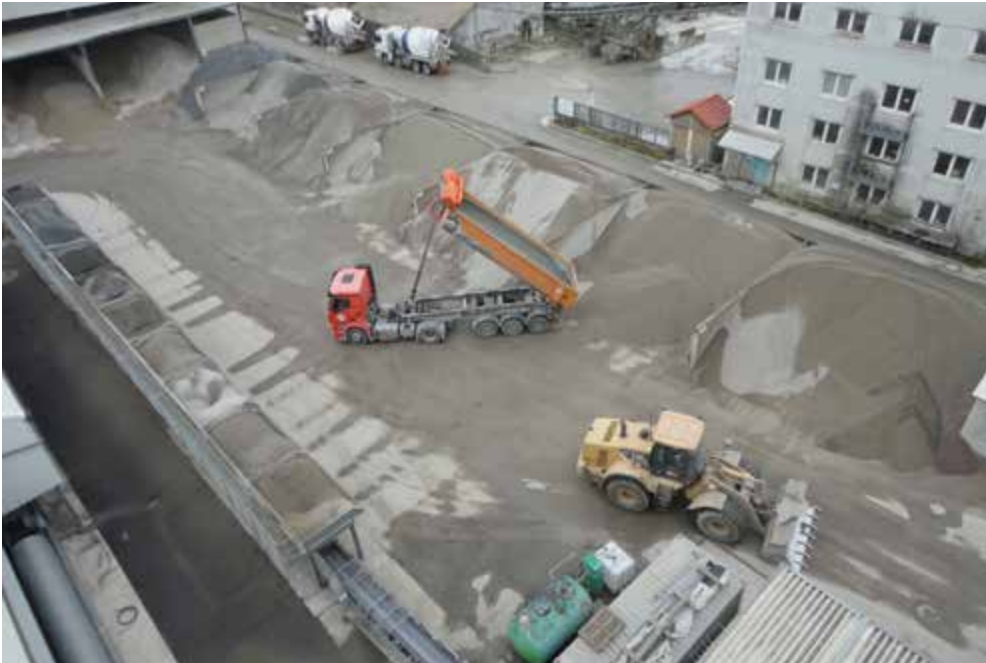
Abb. 7 Entladung in Materialboxen – Fahrzeug steht geradlinig
