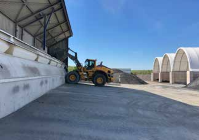
Abb. 6 Beschickung Reihendoseur – sauber gehaltener Bereich vor dem Anschlag
