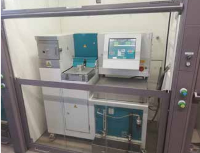
Abb. 85 Geschlossene Extraktions-Anlage nach dem Waschtrommelverfahren (geöffneter Abzug)
