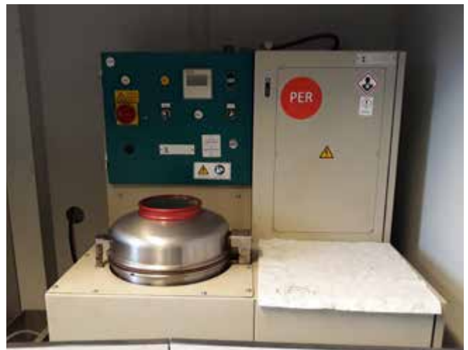
Abb. 88 Bitumenspülmaschine mit Tetrachlorethen (PER) betrieben
