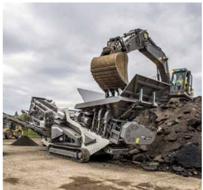
Abb. 55 Materialaufgabe mit Bagger von sicherer Standfläche
