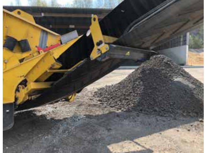
Abb. 57 Gut gesichertes Austragsband der mobilen Anlage
