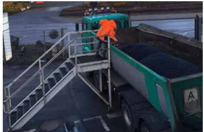
Abb. 80 Probennahmebühne für Mischgutentnahme bei LKWs
