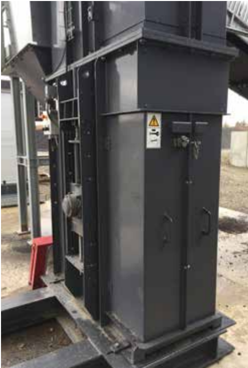
Abb. 33: Becherwerk-Klappe mit Schlüssel-Transfer-System und Vor-Ort-Schaltung
