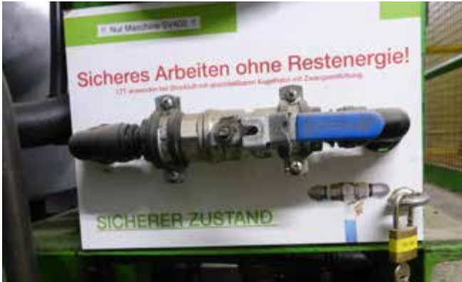
Abb. 69 Absperrhahn für Pneumatik mit Schloss
