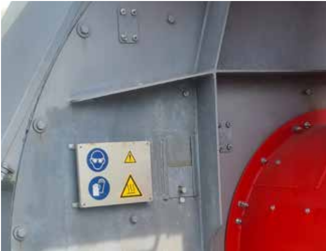
Abb. 37 Hinweis auf vorgeschriebene PSA an der Sichtöffnung
