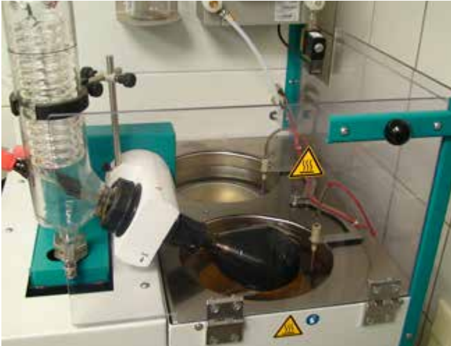
Abb. 89 Asphaltanalysator mit Rotationsverdampfermodul
