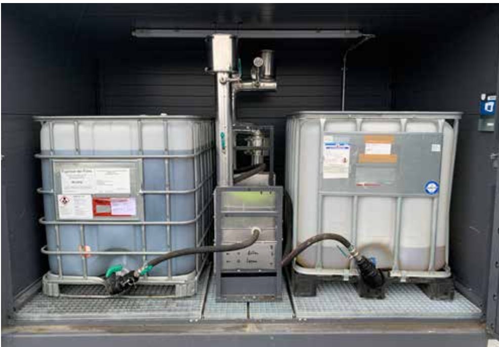
Abb. 19 Lager mit Dosiervorrichtung für Gleit- und Trennmitteln oder andere Flüssigadditive
