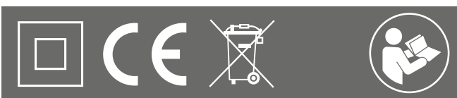
Abb. 19 Typenschild mit Symbol Schutzklasse II → Schutzisolierung
