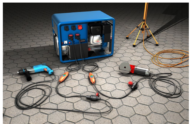
Abb. 16 Jedem Verbrauchsmittel ist eine PRCD vorgeschaltet.
