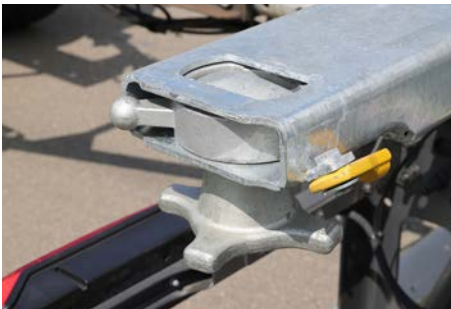
Abb. 14 Stellung der Fallsicherung gegen Rückfall
