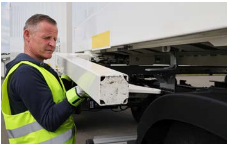
Abb. 8 Stützbein mit Stützbeinstrebe mit beiden Händen herausziehen
