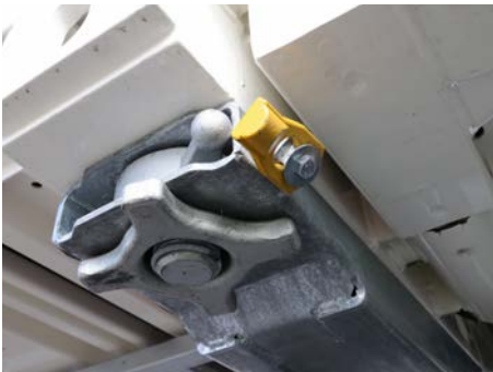
Abb. 14 Stellung der Fallsicherung gegen Rückfall
