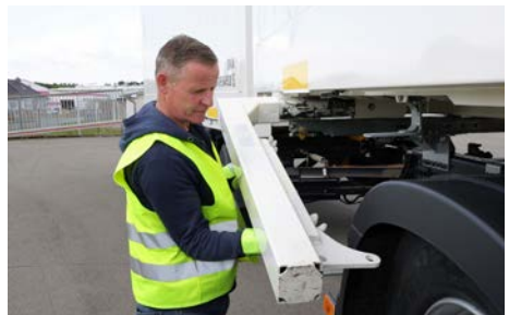
Abb. 9 Stützbein mit Stützbeinstrebe herabschwenken
