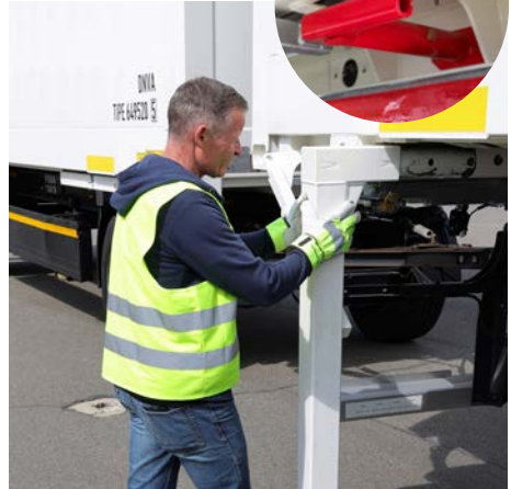
Abb. 13 Stützbeinverriegelung einrasten lassen und Verriegelung kontrollieren
