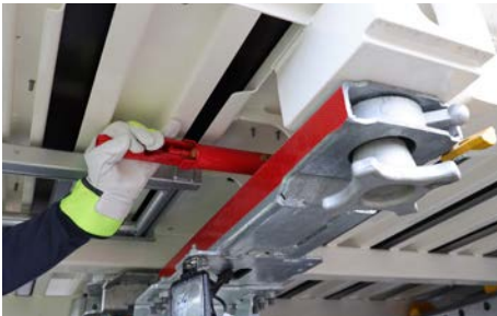
Abb. 6 Lösen der Stützbeinverriegelung
