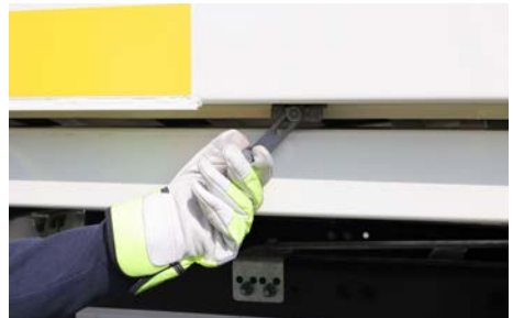
Abb. 7 Lösen der Transportsicherung (Fallsicherung)
