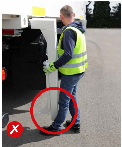
Abb. 11 Achtung: Verletzungsgefahr im Schwenkbereich!
